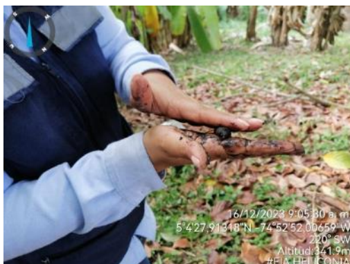
Fotografía 2-6 Ensayo plasticidad del suelo
