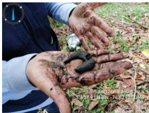
Fotografía 2-6 Ensayo plasticidad del suelo
